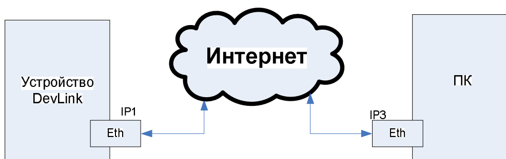
Рисунок 3 – Схема Ethernet– Internet – Ethernet
